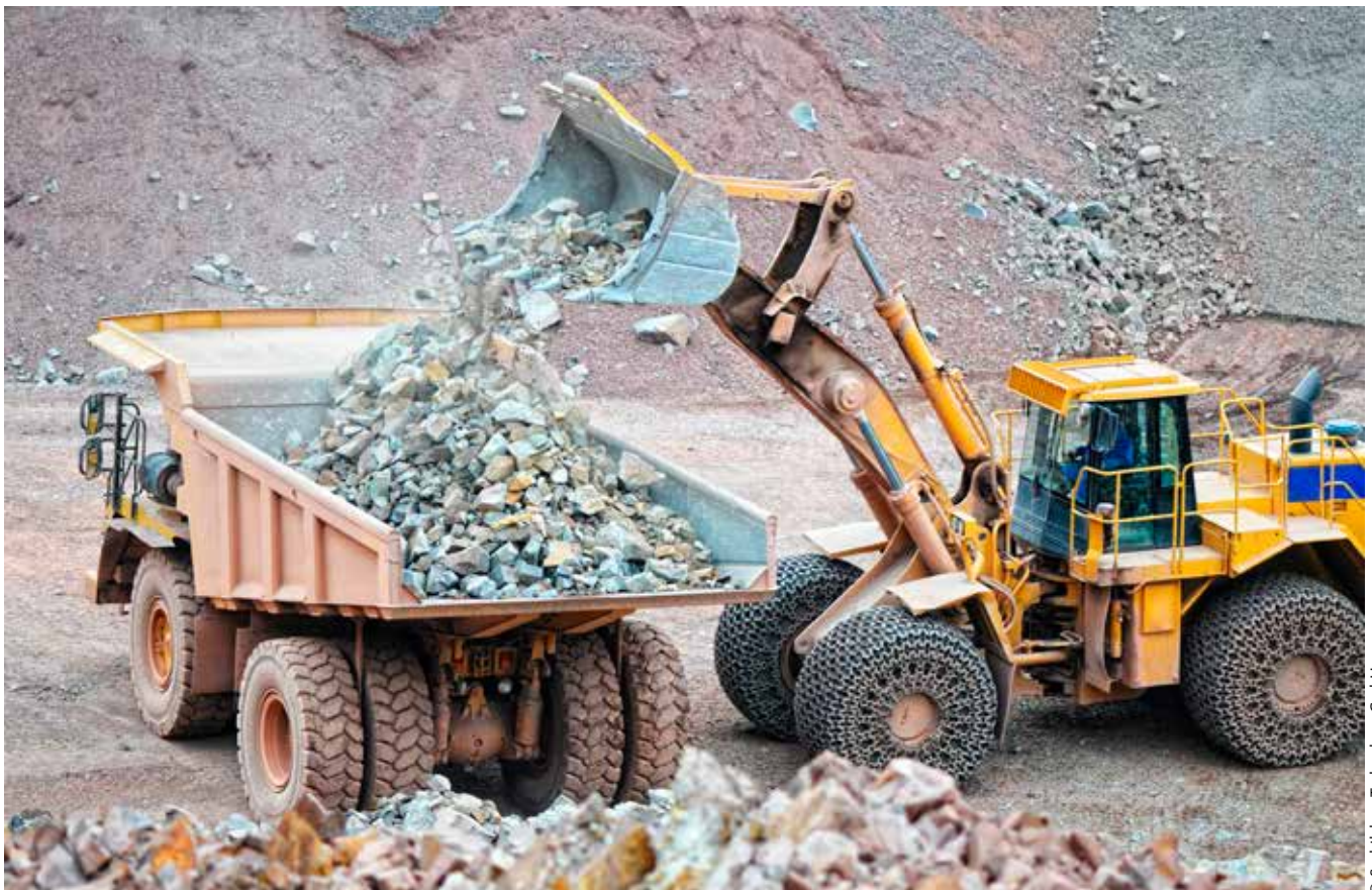
6 Radlader belädt Muldenkipper Wheel loader loading dumper trucks
