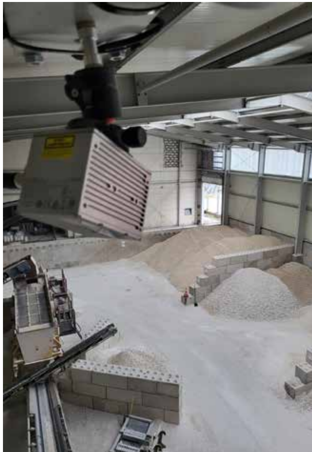
3 Das Owl Eye® wacht über die Bestände in den Lagerboxen The Owl Eye® monitors stock levels in the storage bays
