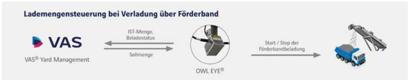
4 Lademengensteuerung bei Verladung über ein Förderband Load quantity control during loading via a conveyor belt
