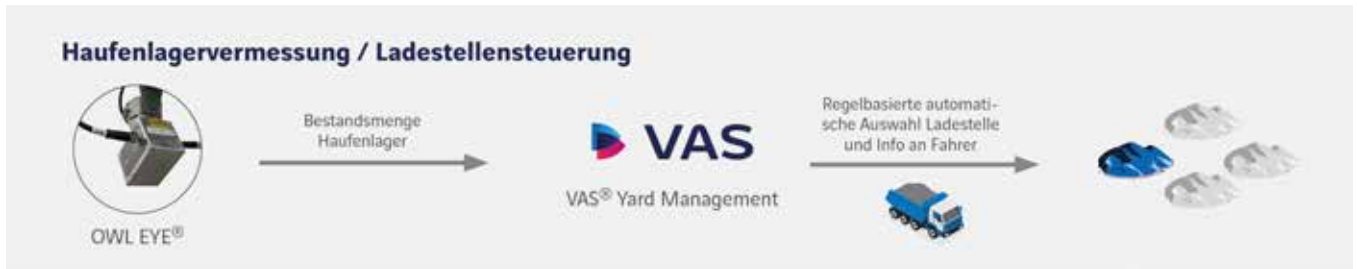
3 Haufenlagervermessung und Ladestellensteuerung Stockpile measurement and loading point control
