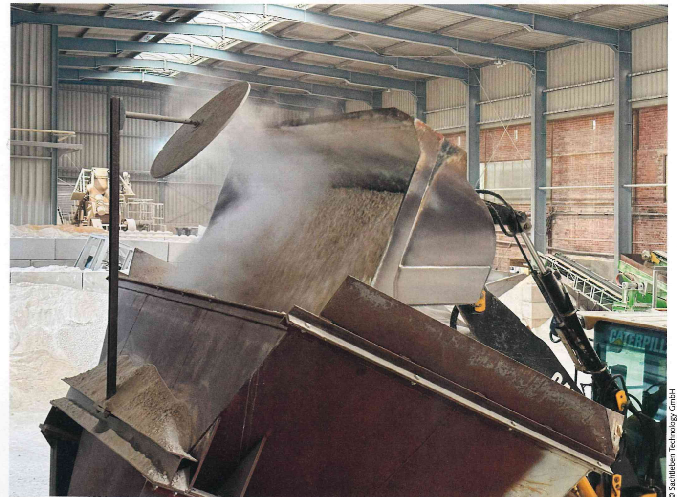
5 Das Aufgabebunkermodul ist für Halden, Aufgabebunker oder andere Behälter einsetzbar The feed hopper module can be used for stockpiles, feed hoppers or other containers
