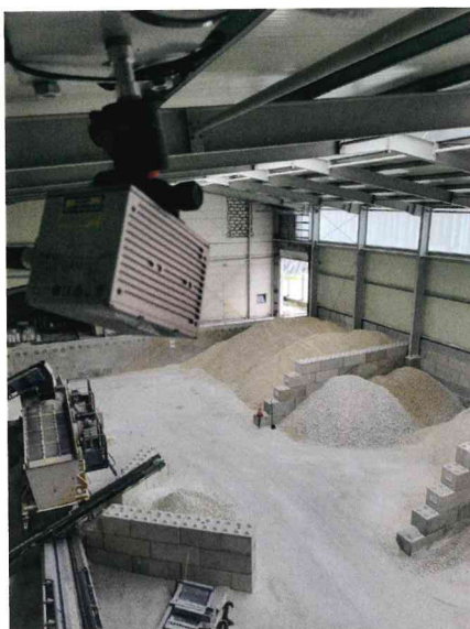
Abb. 3 (links): Das Owl Eye wacht über die Bestände in den Lagerboxen
