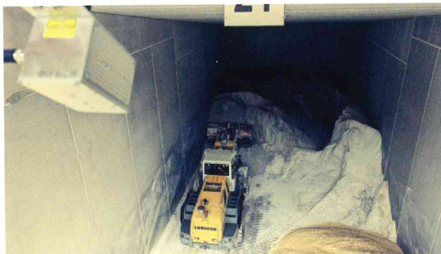
Abb. 1: Owl Eye wacht über die Schüttgutbestände eines überdachten Außenlagers
