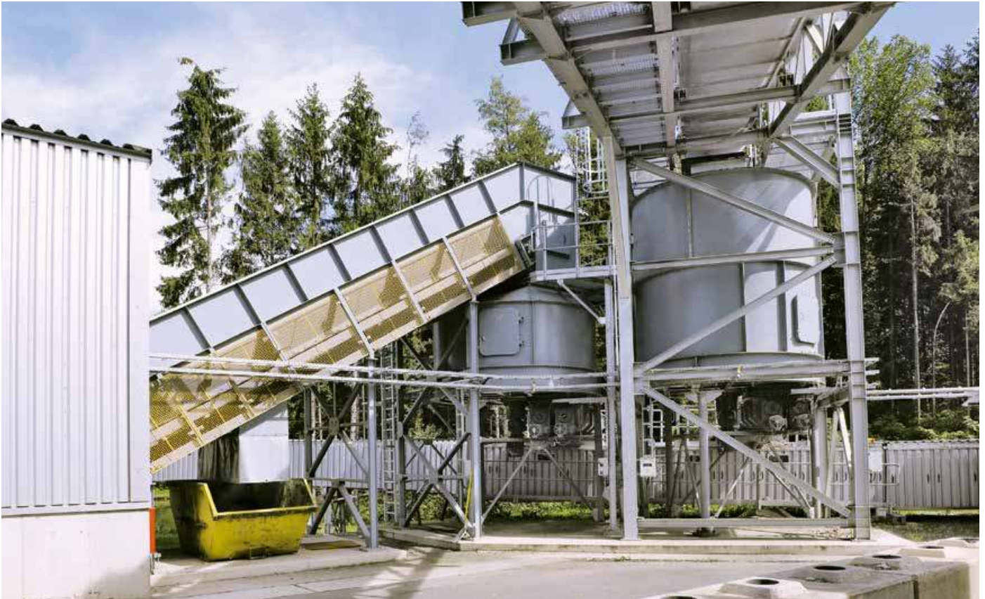
Die BG OptiFeed ist ein Schneckenförderer mit Wägezellen. Damit kann das Material kontinuierlich dosiert werden.
