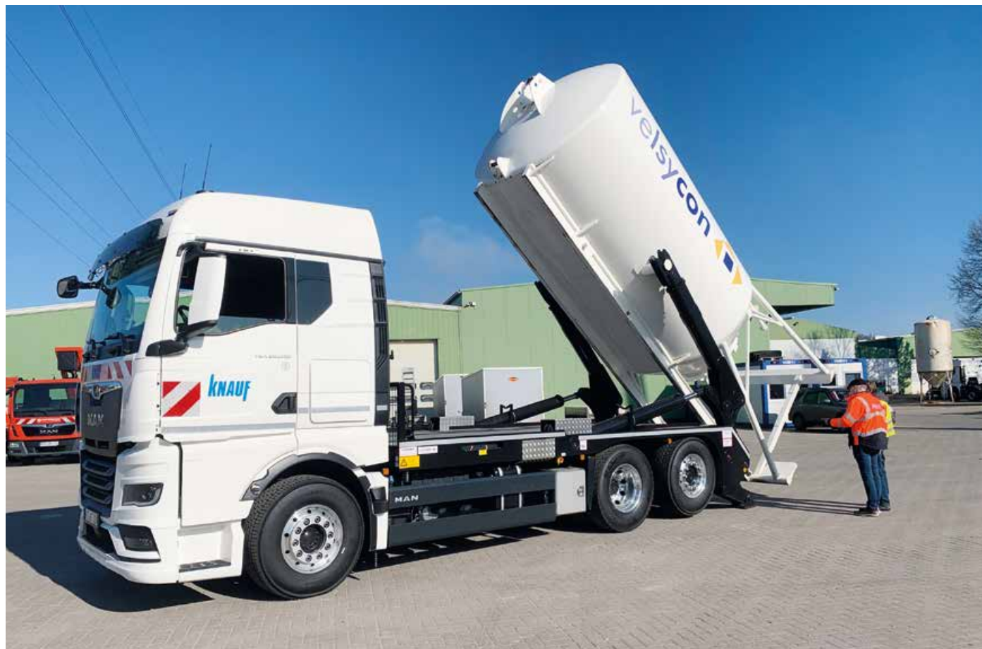
Einweisung vom Team velsycon an Knauf Mitarbeiter beim Aufstellen eines WS22,5-Silo mit Siloabsetzkipper SASK 26.18 (Foto: velsycon)
