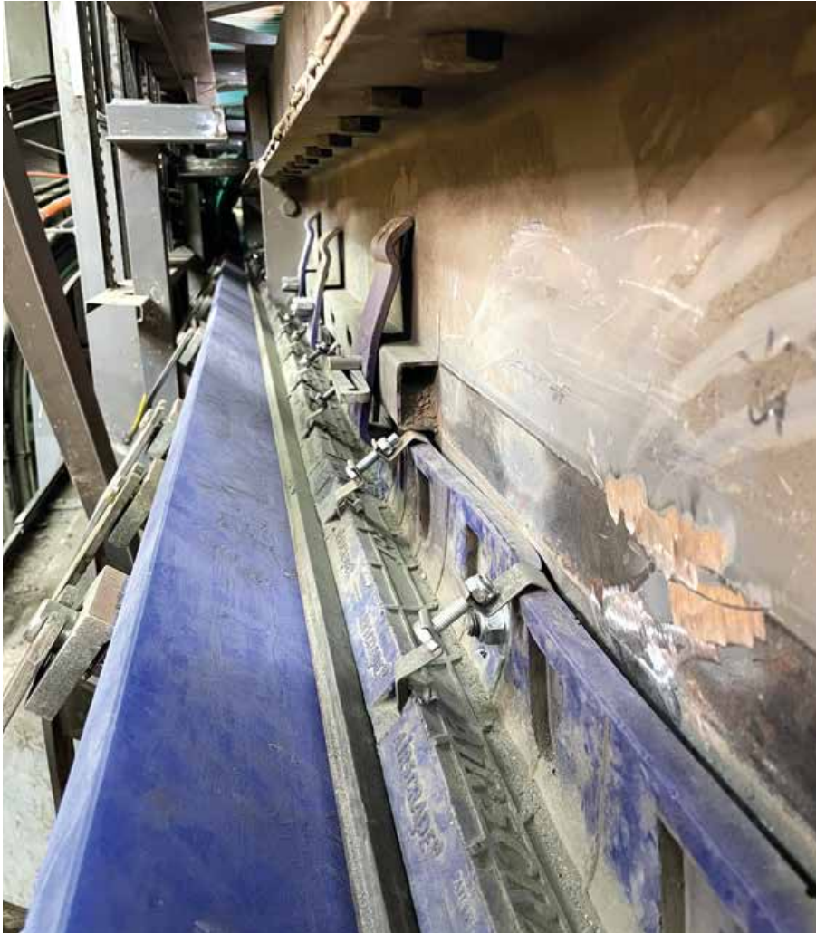
Der SureSupport unterstützt die Abdichtungsfähigkeit des AirScrape und sorgt so für eine optimale Abdichtung im Aufgabebereich
