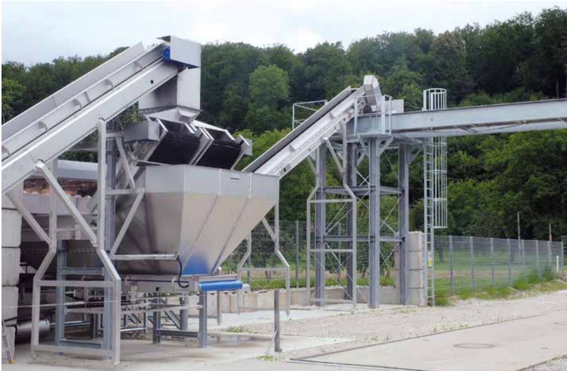
Direkt nach der Anlieferung wird das Obst in dem hier gezeigten Anlagenabschnitt automatisch entlaubt und trocken gereinigt
