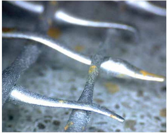
Bild 6: Verschleißbilder eines Siebgewebes aus federstahlhartem Draht MW = 6,3 mm; DS = 1,6 mm
