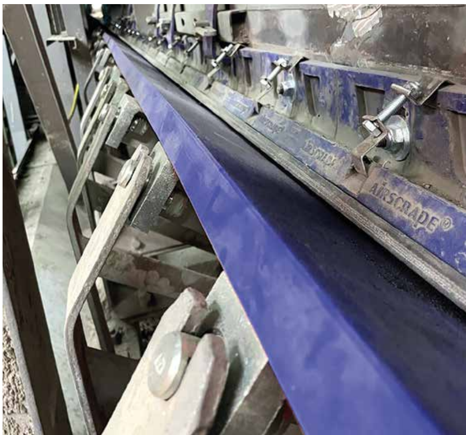
Die Gleitelemente des SureSupport verhindern eine Gurtverformung und gewährleisten so die Dichtigkeit der Übergabe
