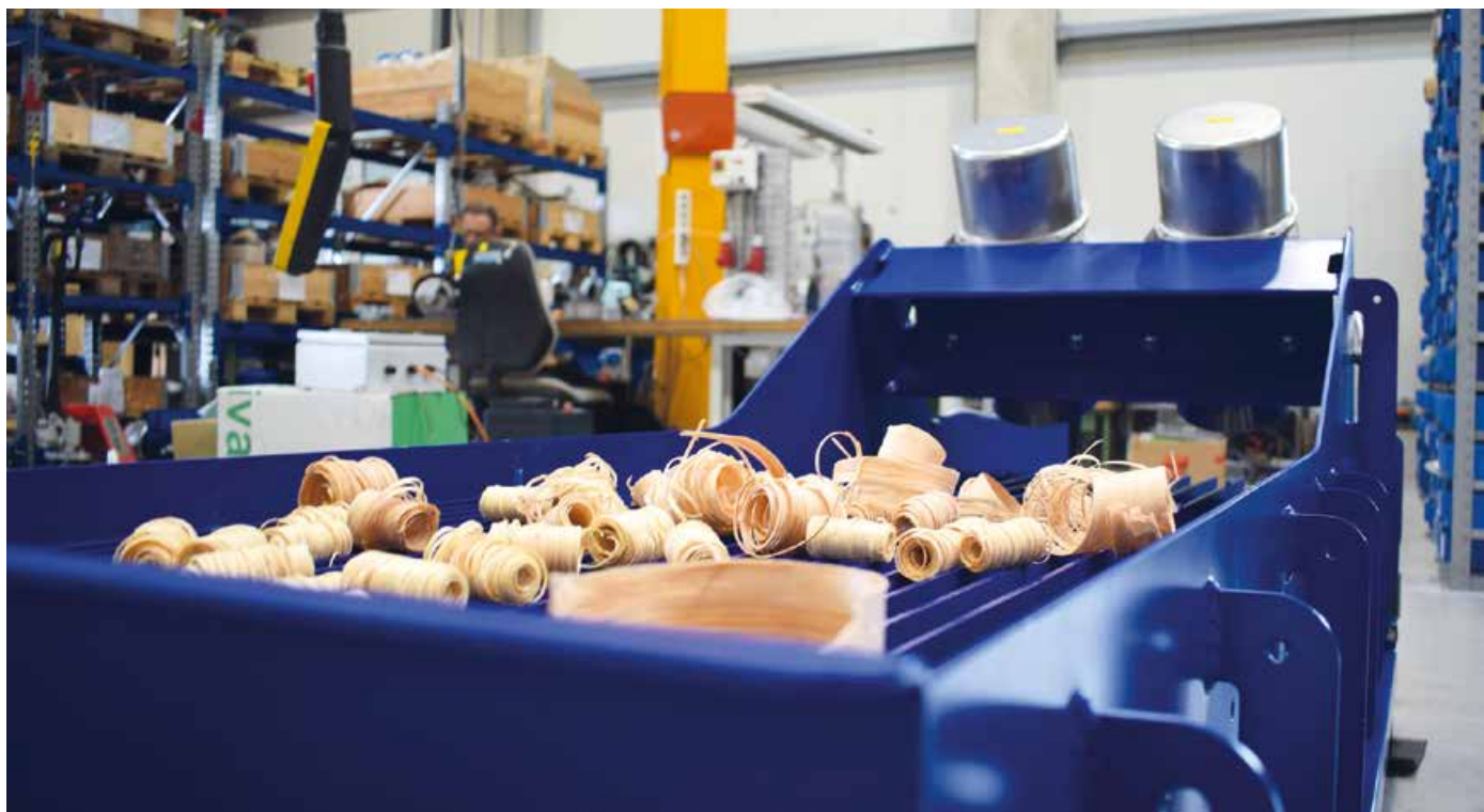
Mit der Siebrinne von NetterVibration werden die produzierten Holzspanlocken dreifach sortiert
