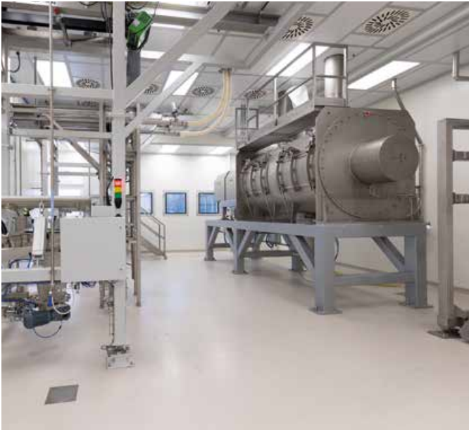
Kombi-Anlage HECHT-Entleerstationen und Lödige Pflugschar®-Mischer
