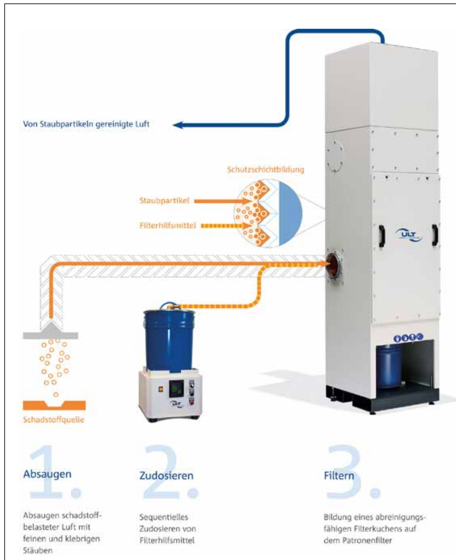
Zudosiereinheit zur Bindung und Filtration klebriger Stäube (Bild: ULT AG)
